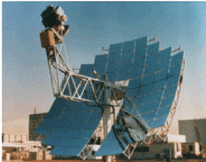
Figure 2. Le système McDonnell Douglas/Southern California Edison, produisant 25 kW e
