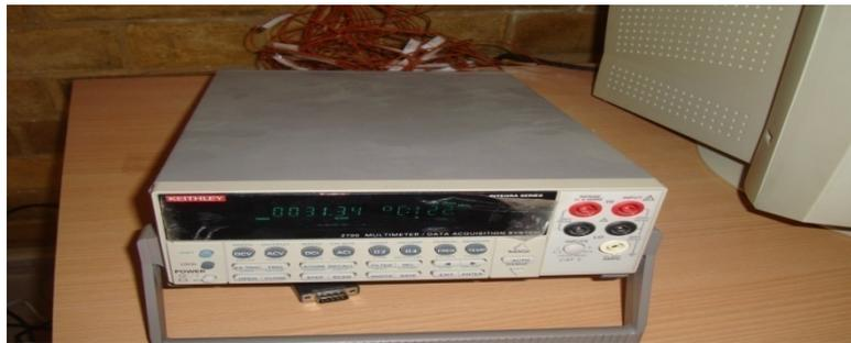
Figure 2 : Système d'acquisition KEITHLEY 2700 (40 voies de mesures)
