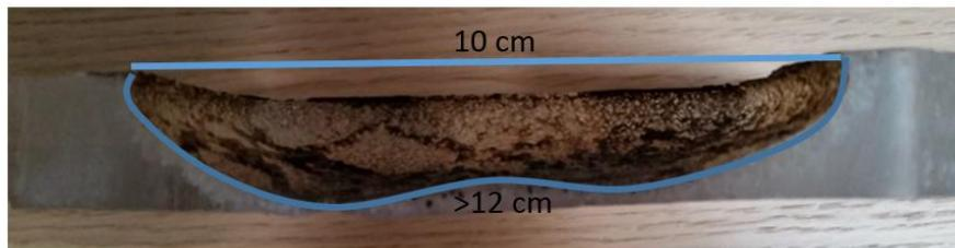
Figure 5 : Coupe d'un échantillon de 10 cm de côté après combustion.
